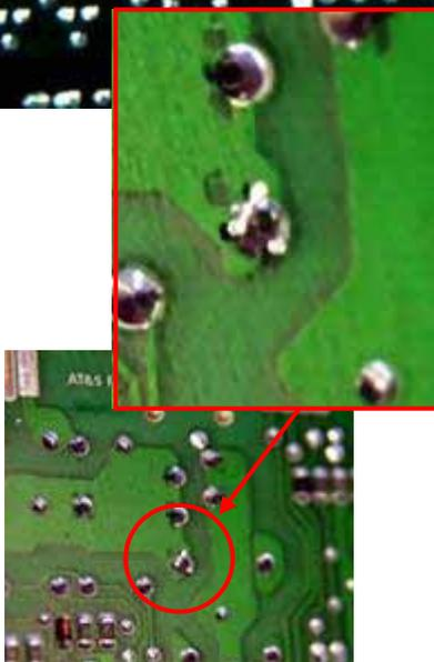
Bei neuen Elektroniken wurde bei der betroffenen Lötstelle übrigens vorgesorgt... (Bild links)
