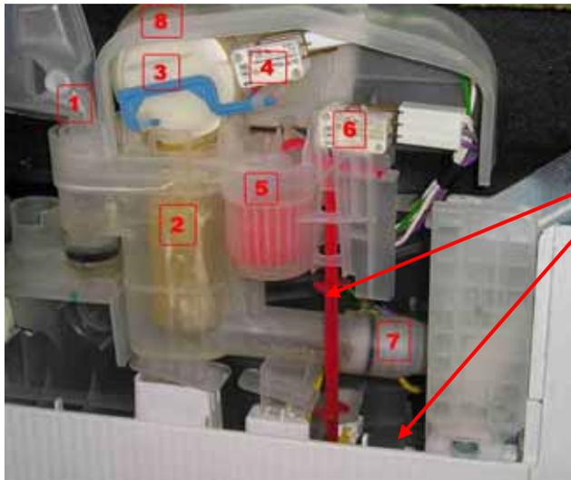
Ursache ist ein ausgelöster Schwimmerschalter (Position 6 im Bild links). Dieser befindet sich hinter der linken Seitenwand (Siehe Punkt 2.4) und wird über den roten Hebelarm betätigt, sobald Wasser in die Bodenwanne geraten ist oder über den Schwimmer (Position 5 im Bild), wenn der Wasserstand im Gerät zu hoch ist. Der Schwimmer (Pos. 5) kann auch dann auslösen, wenn z. B. der Schlauch (Pos. 7) verstopft ist!
