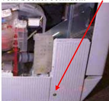
Danach können Sie den Sockel mit einem leichten Ruck abziehen. Heben Sie bitte dabei das Gerät vorne etwas an, da sich im vorderen Sockel die Gerätefüße befinden. Wer sein Gerät in der Küche unterbauen möchte, kann so einen Sockelrücksprung schaffen und die Sockelleiste der Küche verwenden. Die Gerätefüße lassen sich dazu aus dem Sockel schrauben und etwas weiter hinten im Geräteboden wieder eindrehen (Das geht, weil der Geräteboden der gleiche ist wie bei den Einbaugeräten).
