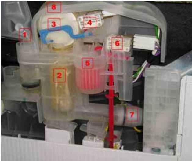
Ist der Wasserhahn nicht die Ursache, dann wird das im Bild dargestellte Niveausystem verstopft/verschmutzt sein, das sich hinter der linken Seitenwand (Siehe Punkt 2.4) befindet.
