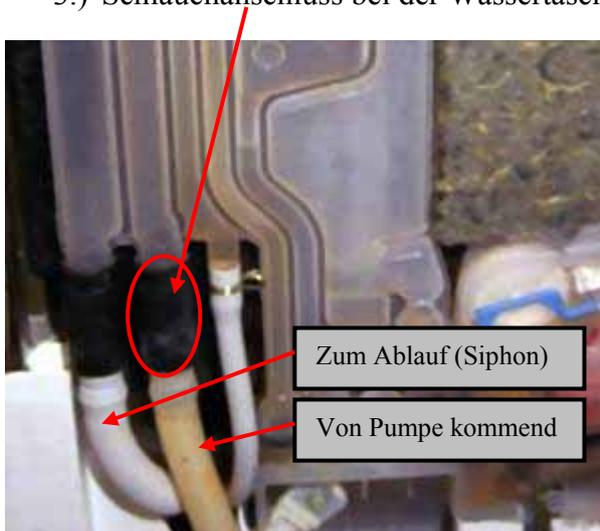
Wenn tatsächlich an diesen drei Stellen kein Fremdkörper zu finden ist, dann müssen Sie die Pumpe überprüfen (Befindet sich hinter der Sockelleiste auf der linken Seite). Entweder sie bekommt keine Spannung (Elektronik defekt?) oder sie ist einfach nur defekt (bekommt Spannung, aber dreht sich nicht, obwohl sie freigängig läuft).
