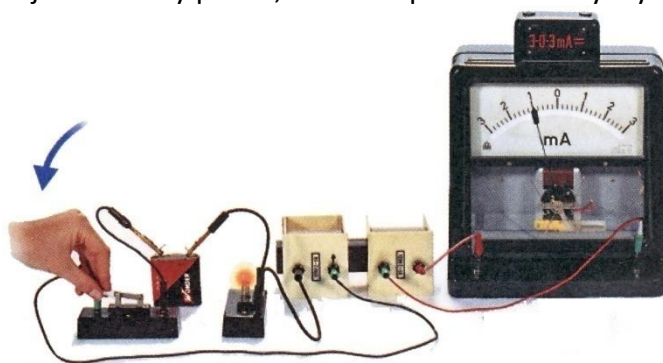
Obrázek 33: Primární a sekundární cívka těsně po sepnutí spínače
