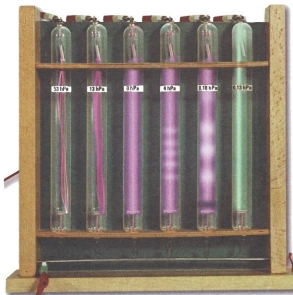
Obrázek 54: Elektrický výboj v trubicích s různě zředěným vzduchem
