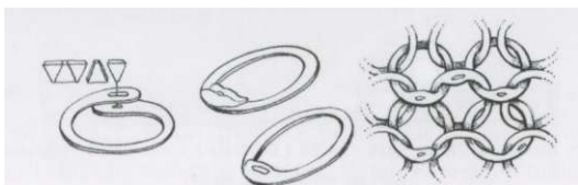
Postup výroby drátěné košile - spojování kroužků
