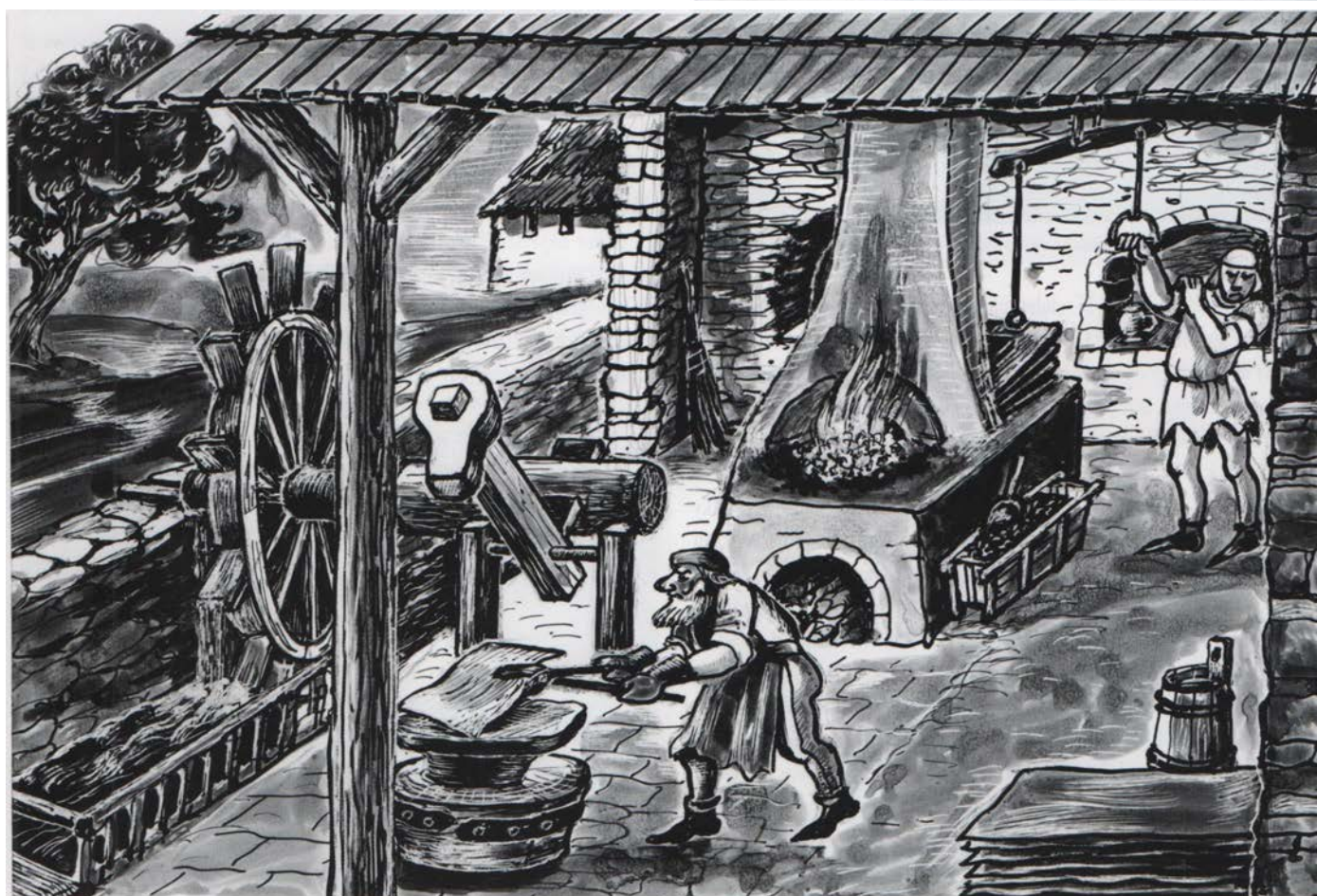
Hamr - vodní kolo se spodním pohonem, výheň a mechanické kladivo
